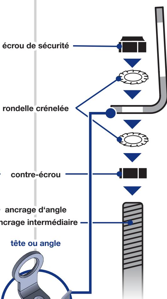
**Pour la protection des filetages, utilisez une pâte de cuivre ou un spray contre la soudure à froid de l'acier inoxydable.**
