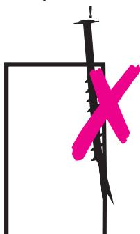
Les 6 vis doivent être complètement vissées l'une après l'autre avec 13 NM jusqu'à ce que la tête de la vis soit à fleur du support.
